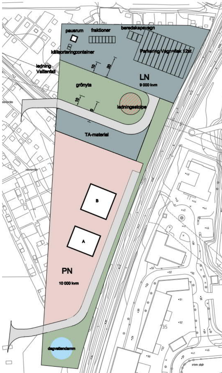
Figur 3. Aktuellt utredningsområde som innefattar bland annat byggnader (A och B), en dagsvattendamm i söder, anslutningsvägar och en parkering i nordöstra hörnet.
